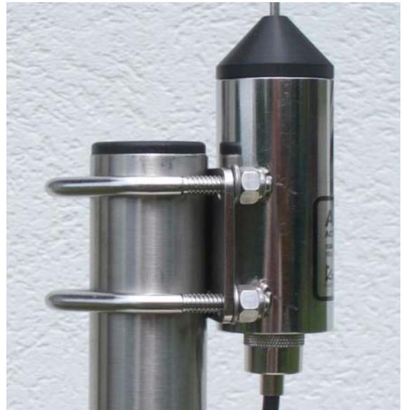
Die Halterung ist so konstruiert, dass diese sowohl auf horizontalen, als auch vertikalen Rohren mit einem Durchmesser von 20 bis 38 mm befestigt werden kann. Entsprechende Rundbügel mit Gewinde samt selbstsichernden Muttern und Beilagscheiben aus nichtrostendem Edelstahl sind beige packt.
